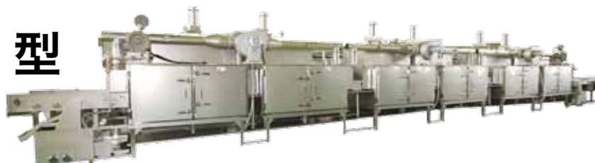
アサヒ装設が開発したガス熱交換器の採用により、ガス熱源の過熱水蒸気オーブンが完成。
